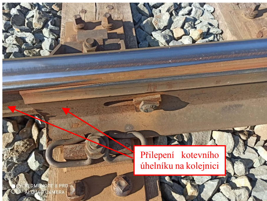
Obr. 20 Příklad uchycení relativního snímače pro měření posunu kolejnice vůči NK
